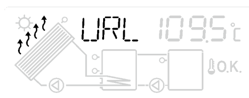
Ilustracja 3: Symbol strzałek i napis URL zamiast napisu KOL sygnalizuje tryb urlopowy.
